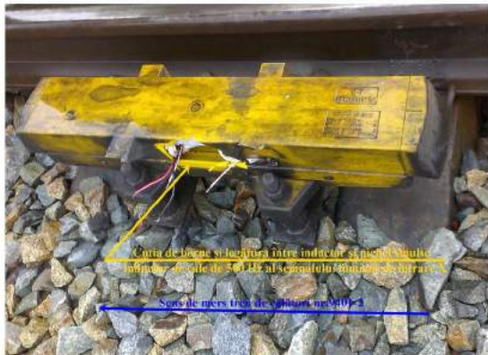
Fig. 3 Inductorul de cale de 500 Hz al semnalului luminos de intrare X al stației CF Potcoava
