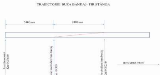
Fig. 6 – schița cu traiectoria buzei bandajului roții atacante
