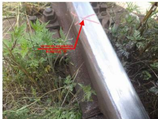
Fig. 5 – urma de escaladare a buzei bandajului pe ciuperca șinei
